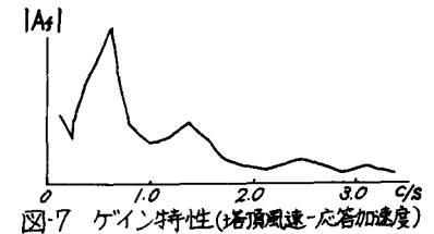
図-7 ゲイン特性(塔頂風速-応答加速度)
