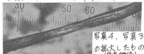
写真3 A粘土の毛状有機物 (倍率100倍)
