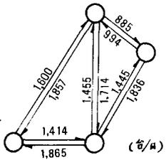
図-4 リンク交通量計算結果
