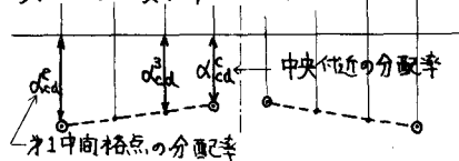
(e) 中央主桁の複線載荷の最大曲げモーメント図
