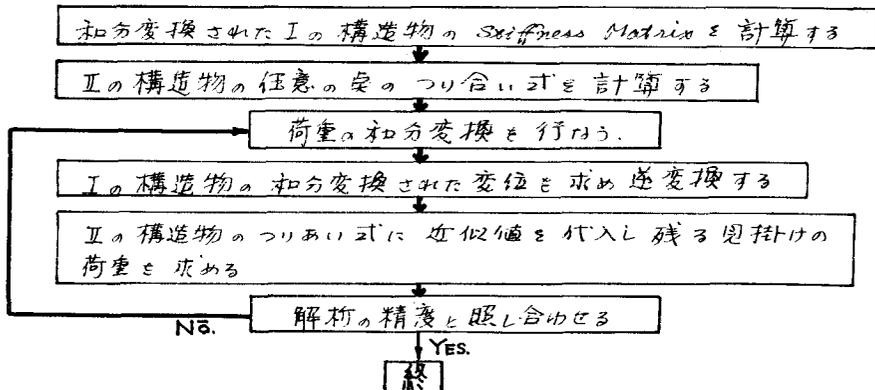
和分変換された I の構造物の Stiffness Matrix を求めるのに 例として 平行弦ワレントラスを考える。(図1)。任意点  $r, r+\frac{1}{2}$  点で力のつりあいをとり、部材力と変位の間に Hooke の法則を考えると変位と力のつりあいの差分式を求める。これを和分変換すると次の式にたどり着く。ただし、 $u$  は水平  $v$  は鉛直変位
