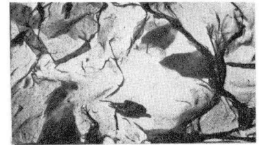
電子顕微鏡写真-2 カオリン締固め土のランダム構造 (締固め方向に垂直な面) ×8000
