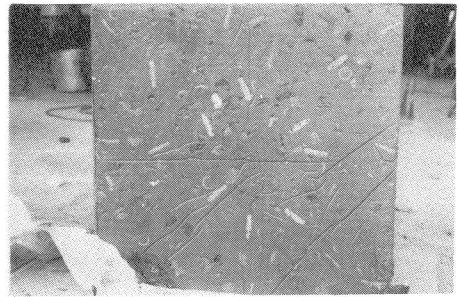
写真-2 溶液を予備注入したブロック
