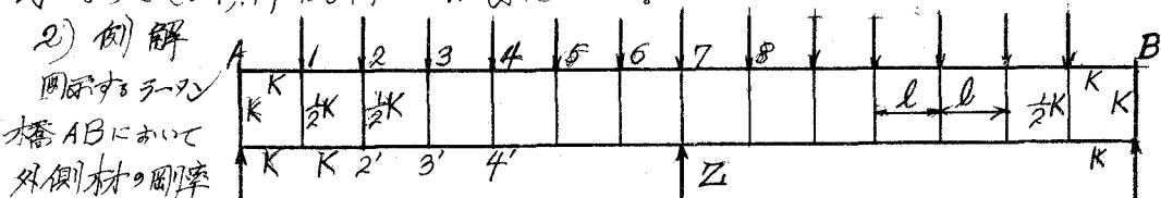
を  $K$ 、内部の総ての柱材の剛さを  $K$  とする。上部各節点に荷重  $P$  を与えた場合、また更に中央に元支承(反力  $Z$ )を加えた場合について、部材の  $M$  及び反力  $Z$  の計算。
