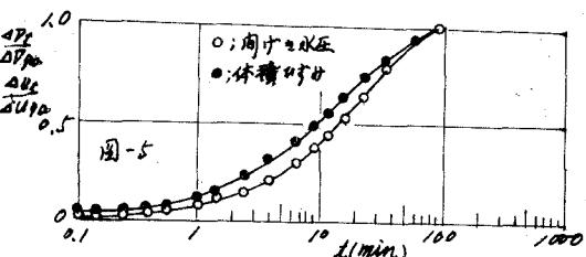
(水平方向排水の場合では圧密が速く進むので90分を基準にとってある)
