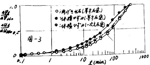
図-3で破線で示したのは一次元圧密における体積ひずみである。等方圧密における体積変化より変化の速度が遅く、むしろ間げき水圧の方に遅い。
