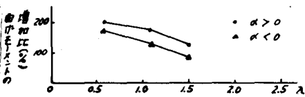
図-4 斜間隔 \lambda_1 と先進トンネルの影響
