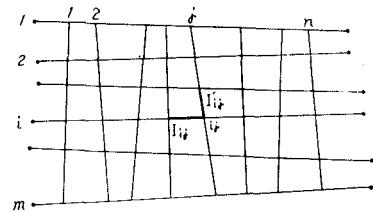
まず、主桁に関して、荷重を  $P_{ij}$ 、横桁反力を  $X_{ij}$ 、曲げモーメントを  $M_{ij}$ 、たわみを  $y_{ij}$  とすれば
