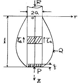
次に杭底面の反力を求める。杭底の深さ  $Z=l$  で考えてみると式(3)で示されるような鉛直方向の変位  $W_s$  があるから、この鉛直方向の変位  $W_s$  を  $Z=l$  の面の境界条件として与えるようなら杭底面の圧力を求めることになる。厳密にいえば水平方向の変位もあってそれも境界条件として与えるべきであるが計算を簡単にするため  $r=a$ ,  $Z=l$  の位置で示す鉛直方向の変位  $W_s$ だけを取り出してその  $W_s$  と杭底面の分布圧力との関係を求めた。この一つの方法として Mindlin の式を積分して地中で円形等分布する鉛直荷重の沈下を次のようにして求めた。
