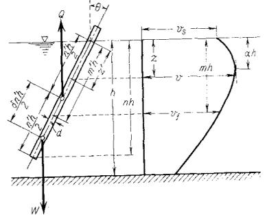
$$\begin{aligned} & \int_0^{m'h} \frac{w C_D d}{2g} (v \cos \theta - v_f \cos \theta)^2 (m'h - z') dz' \\ & + \int_{m'h}^{n'h} \frac{w C_D d}{2g} (v_f \cos \theta - v \cos \theta)^2 (z' - m'h) dz' \\ & = \frac{\delta n'h}{2} \sin \theta \times W = \frac{\delta n'h}{2} \sin \theta \times \frac{\pi}{4} d^2 n'h w = \frac{\pi}{8} w \delta \sin \theta d^2 n'^2 h^2 \end{aligned} \quad (5)$$
