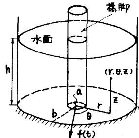
いま、考る領域を  $h \geq z \geq 0$ ,  $2\pi \geq \theta \geq 0$ ,  $b \geq r \geq a$  とし、橋脚の運動加速度を  $f(t)$  とすれば境界条件式はつぎのように表わされる（ただし、 $\rho$ : 水の密度）。
