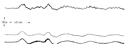
オ3図 佐々並川ダム 上の曲線は上端の地震記録 下の曲線は下端の地震記録 中の.....計算値
