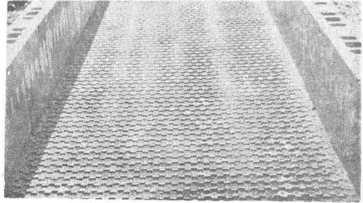
写真-5, 実験後の砂の堆積状況(千鳥配置)
