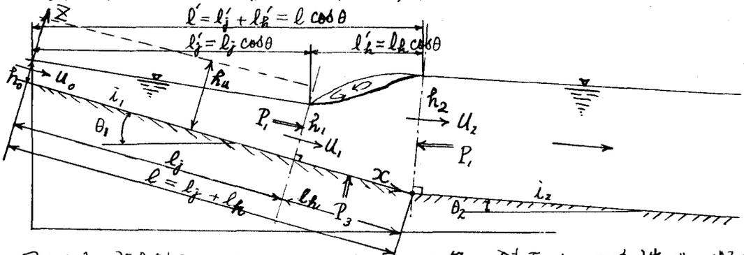
図のように複合斜面  $i_1, i_2$  ( $i_1 > i_2$ ) において第1斜面  $i_1$  の下流端で生ずる跳水について考えると、衝力方程式から次式が得られる。
