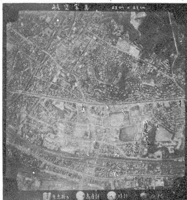
視差法 オーバーラップさせて撮った2枚の写真上に写っている同一物の、その2枚の写真上に於ける相対的ずれを視差という。視差は、2枚の写真と並べて立体的に見ることによって簡単に測定できる。視差と自動車の速度との間には、次の関係があるから、速度は直ちに計算できる。5%位の精度なら、附随地上測量は必要ない。
