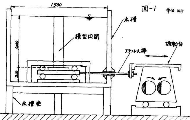
(3) 実験結果とその検討 直径76mmの模型円筒を全振幅1.0mmで振動させたときの円筒下端でのひずみを図-2に示した。同図から明らかのようにこの模型の固有振動数は1200 c.p.m.であるが、この模型を水中で振動させると500 c.p.m.で共振現象が生じている。このように水中で振動する棒状構造物では、その固有振動数より低い振動数で空中での最大値に相前後する応力や変位を生ずることがわかる。また動水圧に関して解析を行なった結果から、水中構造物に作用する動水圧は構造物をとりまく水のフルード数Frまたは震度K<sub>0</sub>の関数として表わせ、これらのFr, K<sub>0</sub>が小さな場合には動水圧は構造物に対して加振力として作用し
