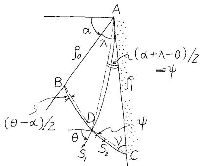
この場合に対して左図を考える。図で  $AC$  は壁面、土はその左側に拡がり  $BAC$  が過渡域となる。（粘着力があり  $C \neq 0$  一地表面が傾斜せる時は一般に  $AB$  は曲線となる）。 $S_1$  辺り線は壁と  $A$  点で切し、限界線上の一点  $B$  より出る  $S_2$  辺り線を  $BDC$  とする  $AD, BD, DC$  は内弧と考へて実用上十分である。
