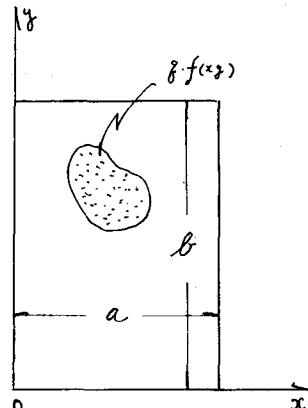
$$(4) \quad \left\{ \begin{array}{l} M_x = 8b^2 \left( \alpha^2 \frac{\partial^2 \delta}{\partial z^2} + \nu \frac{\partial^2 \delta}{\partial y^2} \right) \quad x \text{ 方向曲げモーメント} \\ M_y = 8b^2 \left( \frac{\partial^2 \delta}{\partial y^2} + \nu \alpha^2 \frac{\partial^2 \delta}{\partial z^2} \right) \quad y \text{ 方向曲げモーメント} \\ M_{xy} = 8b^2 d \frac{\partial^2 \delta}{\partial z \partial y} \quad 扭りモーメント \end{array} \right.$$
