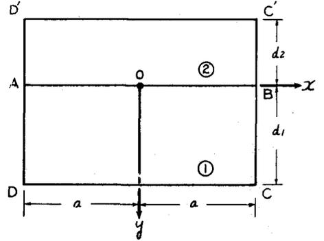
そこでまず手始めとして図に示すような剛性率の異なる2種の矩形材を一樣な強さのシャークネクターで結合した合成桁材の Saint Venant の捩りについて理論解析をこころみた。記号の使用にあたって ABCD 材に関するものは添符 1, A B C' D' 材に関するものは添符 2 をつけて区別する。
