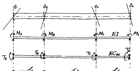
支間は橋軸線に取り、又水の不静定反力は曲げモーメント $M$ と接りモーメント $T$ との二成分に分割が出来る。
