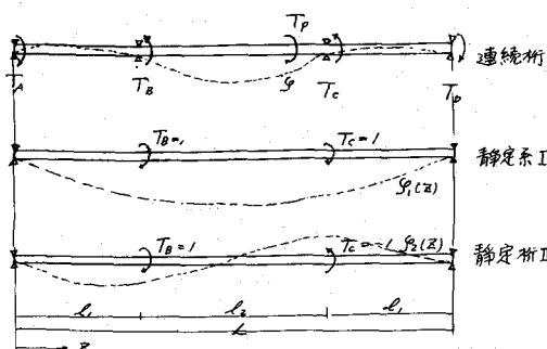
+1,  $T_c = +1$  の作用する時の接れ角を  $\phi_1(z)$ ,  $T_B = +1, T_c = -1$  の作用する時の接れ角を  $\phi_2(z)$  と現せば、反力の影響線は
