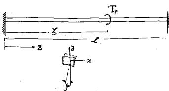
単純に支持された箱桁が、外力のトルク  $T_p$  を  $z = 0$  に受ける時の  $\phi$  の解は、境界条件より  $z = 0$  で  $\phi = \phi'' = 0$ 、更に  $z = l$  で  $\phi = \phi''' = 0$ 、及ぶ  $z = l$  の連続の条件  $\phi_L = \phi_R$   $\phi'_L = \phi'_R$ 、 $\phi''_L = \phi''_R$  を代入すれば下式を得る。
