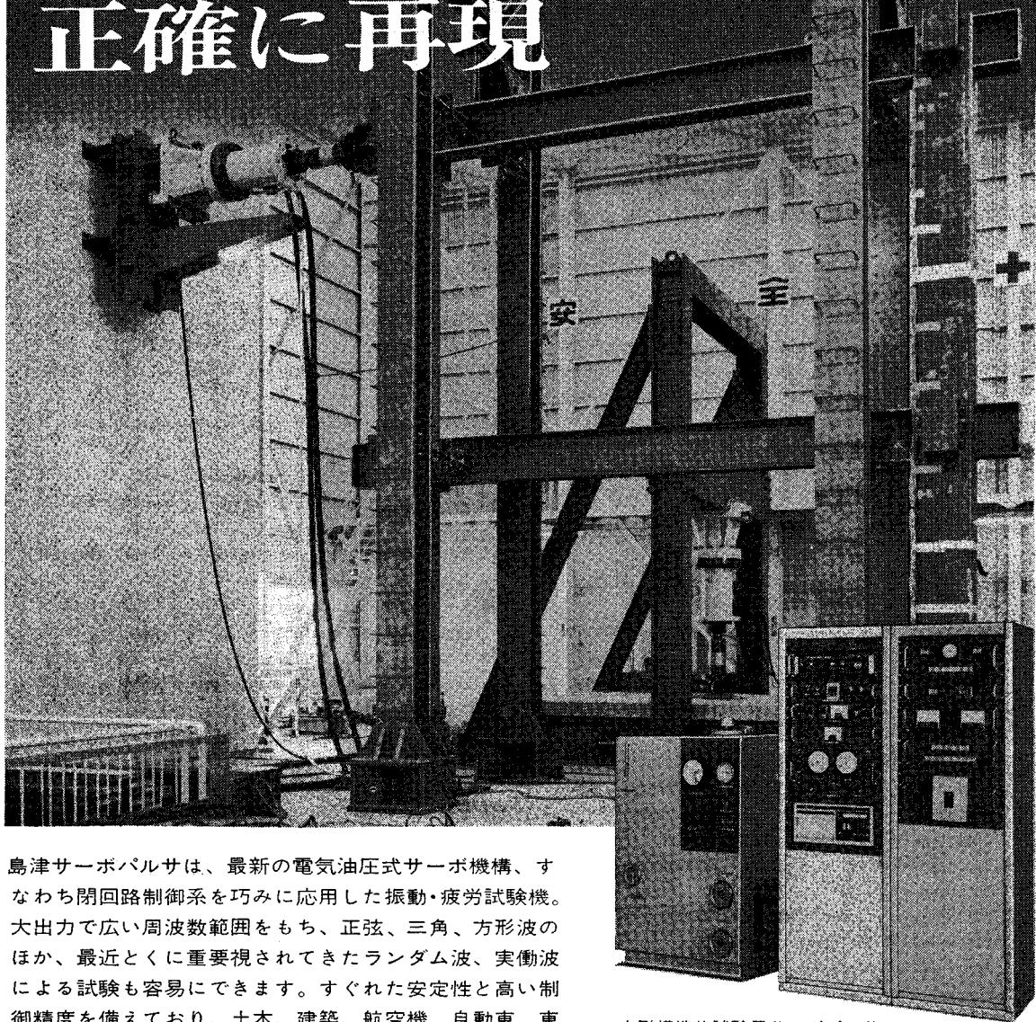
島津サーボパルサは、最新の電気油圧式サーボ機構、すなわち閉回路制御系を巧みに応用した振動・疲労試験機。大出力で広い周波数範囲をもち、正弦、三角、方形波のほか、最近とくに重要視されてきたランダム波、実働波による試験も容易にできます。すぐれた安定性と高い制御精度を備えており、土木、建築、航空機、自動車、車両、船舶、原子力、電気、機械、金属、非金属工業などあらゆる分野における研究と品質管理に最適です。
