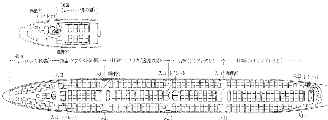
図-1 ボーイング 0747-SR 客室内部配置図
