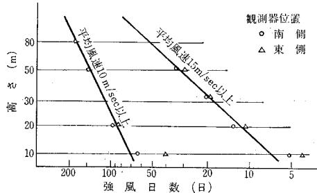
長大吊橋の設計では、風の上下変動と台風の上下・左右のひろがりにおける変化と進行方向の強弱の波形などが問題となる。また、工事面での風の影響も重要で、台風ばかりではなく、アジア大陸の東海岸に位置するわが国の気象特徴の一つである西からの強い季節風が問題である。特に高所作業とか船を使っての重量物取扱いなどは平均風速が 10 m/sec 以上になると困難で、しかも、20 m/sec 以上になると相当の被害なり手戻りを覚悟しなければならない。
