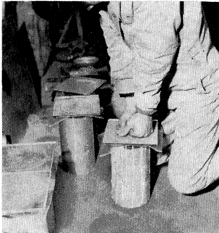
パップモールド成形供試体にキャッピングをしているところ(ビニール紙使用)
