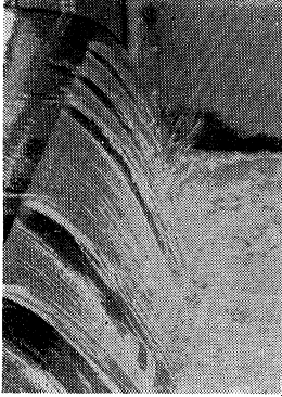
写真-4 スポイラー取り付け (越流水深 5 cm)
