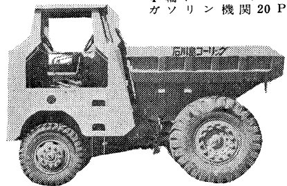
60 W S 形 ダンプカー (回転座席式) 積載量 7.5 吨 (4.8 m 3 ) 走行最高速度26.6km/h ディーゼル機関109 P S
