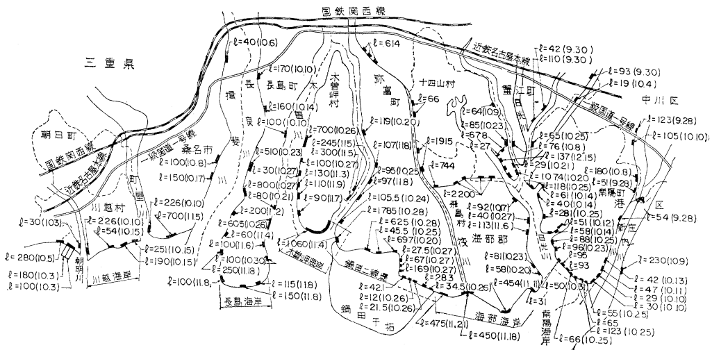
図-1 伊勢湾北部破堤状況と応急締切り完了期日
