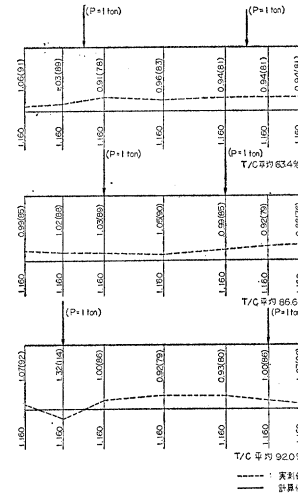
図-6 (b) 偏心曲げによる 1/2 断面のたわみ単位 (mm)
