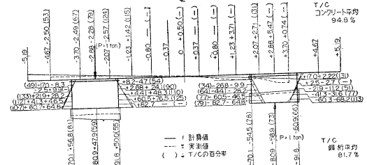
図一7 (c) 偏心曲げによる 1/2 断面の垂直応力の分布 (単位 \text{kg}/\text{cm}^2 )
