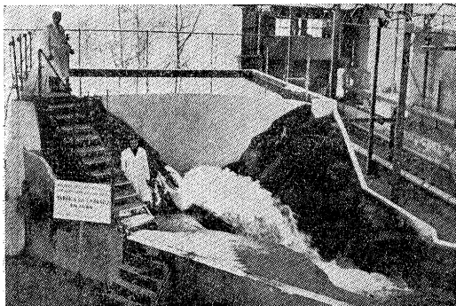
写真一8 Toulouse 大学の水理研究所 (Karadj ダムの 1/60 水理模型実験)
