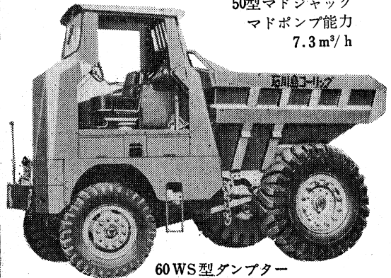
60WS型ダンプター 積載重量 7.5吨 廻転座席型
