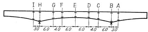
図-18 (a) 死荷重による鉄筋ヒズミ B.H. 下縁 (图中 No. は横断方向の測点 No.)
