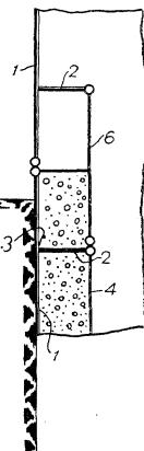
じになり（円筒の上下端に取りつけることになるから）、バックリングの危険性があつたが、この発明はこの欠点を除くべく、内外円筒を半分だけずらせて配置し、繫着部材の一端をどちらかの円筒の上端に、また他端を他の円筒の中腹に取りつけるようにして、取りつけ作業は従来どおり外部から行えるとともに、その間隔を従来のものの半分（円筒の高さの半分）にしたものである。図は本発明の一実施例を示すもので、(1)は外円筒、(6)は内円筒、(2)は繫着部材を示している。
