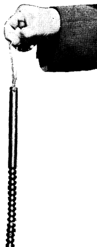
図-4 地下水位精密測定用ゲージ
