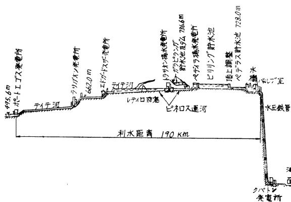
註：トラサオんならびにペディラ揚水発電所で、ティテ河の水を上流ビリリング貯水池(12億m³)に揚水、クバトン発電所に補給する。
