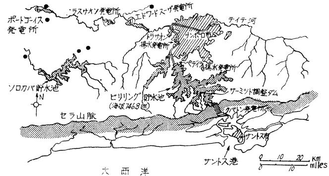
註：サンボーロ市近傍ティテ河上流に12億トンの大貯水池を作り、流域を変更して720mの落差を利用し70万kWの発電をしている。
