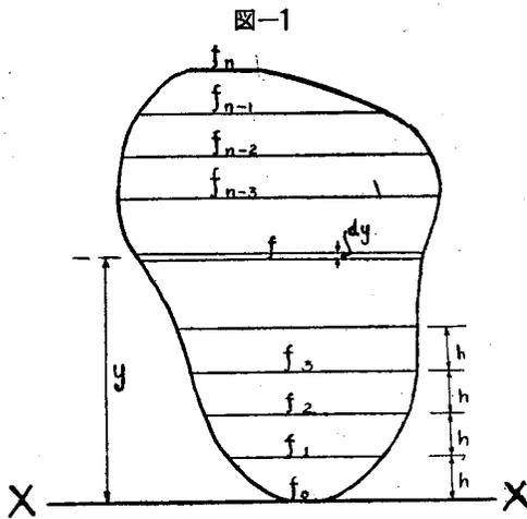
表-1の如く横距 $f$ を並べ次の欄に面積の項として最上部は $1/2 f_n + f_{n-1}$  その次よりは $f_{n-1} + f_{n-2} + f_{n-3}$ ,  $f_{n-3} + f_{n-4} + f_{n-5}$ ,  $\dots$ ,  $f_5 + f_4 + f_3$ ,  $f_3 + f_2 + f_1$  と一
