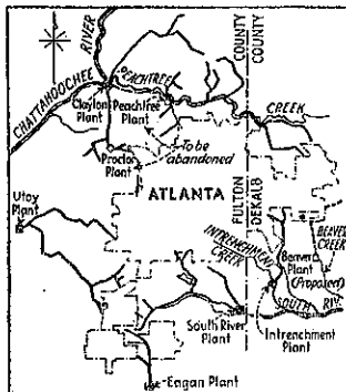
圖-30. Atlanta に於ける 下水管及處分場配置圖
