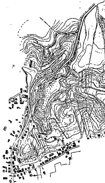
第6圖 修正せる航空寫眞とそれより作れる線地圖
