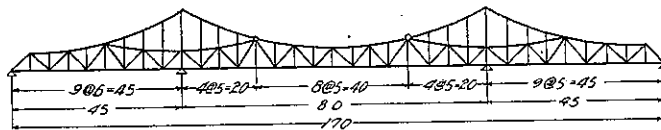
③ 吊塔付控架構橋
