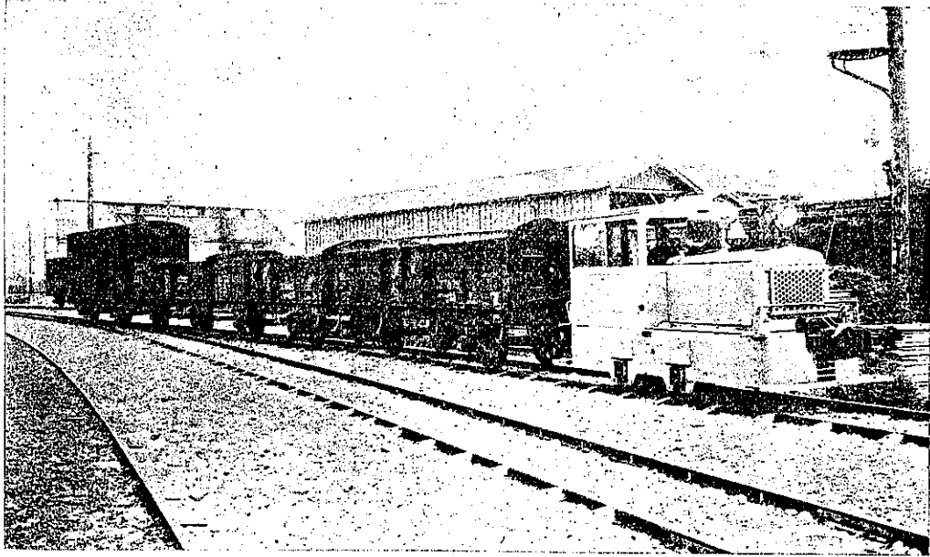
旭絹織株式會社にて貨車入換用にホキットコム拾噸車使用實況
