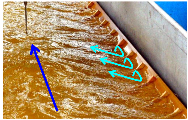
写真-2 側壁粗度後方の水面近傍の水平渦 (RR10)
