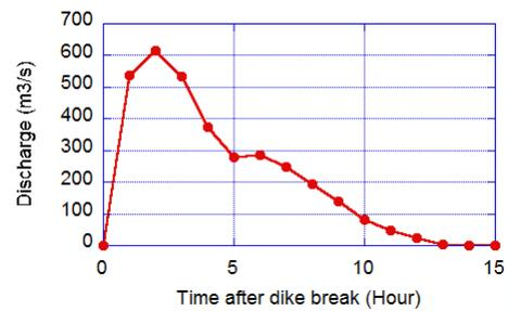
図-3 破堤流量のハイドログラフ
