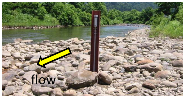
図-2 観測機器の光電式砂面計
