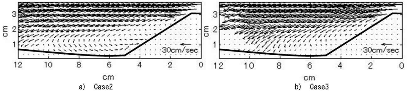
図-7 砂粒子の時間平均速度
