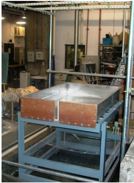
写真 -1 実験装置の概要 ：中央の Box 部分が水路であり、ここに模型斜面を構成する。また、写真上端に設置されたノズルを通して斜面に粒状の人工降雨を与える。水路手前に見えるのが、斜面下流端に設けたスリット状の開口部であり、ここから水および土砂が流出する。
