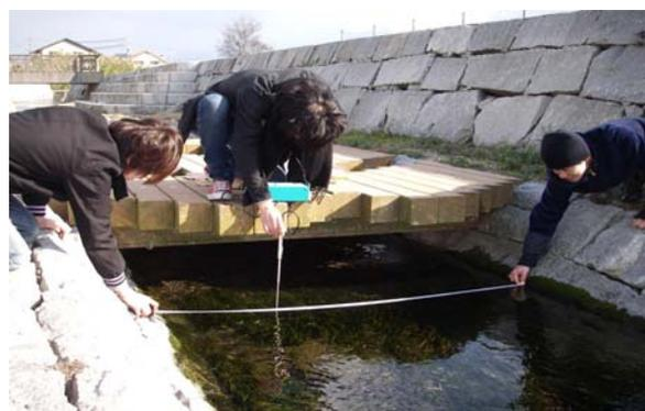
写真-2 流速測定状況 (日下泉直下流)
