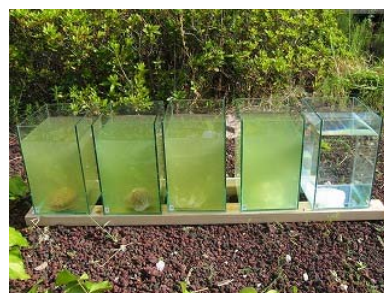
図-2 ため池水を用いた溶出実験の様子（ケース3） （左から順に、水槽1～5）
