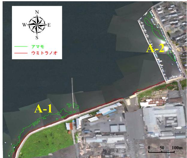
図-6 気球画像をモザイクして目視によりトレースしたA地点の藻場分布図
