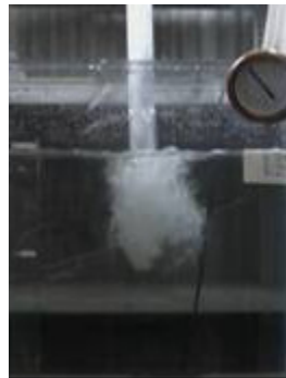
写真-2 CASE II (パターンB) の流況 ( Q=70\ell/\text{min} , D=5\text{cm} , H=10\text{cm} , \ell=10\text{cm} , d=11\text{mm} , n=6 )
